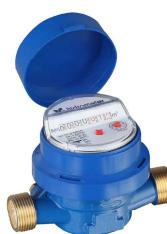
Hidrômetro com **relojoaria inclinada** 45° e giratória 360° com trava, facilita a instalação no plano horizontal, possibilita ao leiturista, leitura local com grande distância, sem a necessidade de inclinar o medidor, garantindo assim desempenho metrológico classe B.
