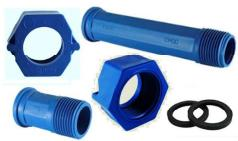
A opção entre utilizar latão ou PP é caracterizada em função da pressão de operação da linha de abastecimento, ou material da tubulação da instalação, se a tubulação for de material metálico com pressão de trabalho superior a 3 bar, a aplicação deve ser com as conexões em latão, se for abaixo de 3 bar com tubulação em PVC, utilizamos as conexões em PP.
